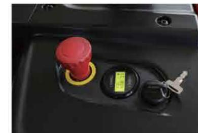
Display LCD multifunción que muestra el nivel de batería, los códigos de error, la velocidad, el tiempo de uso y más información.
