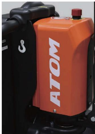
Circuito de elevación hidráulica sin mangueras ni tubos, lo que mejora significativamente la fiabilidad y reduce la cantidad de problemas potenciales relacionados con las fugas a través de los conectores o sus juntas.
