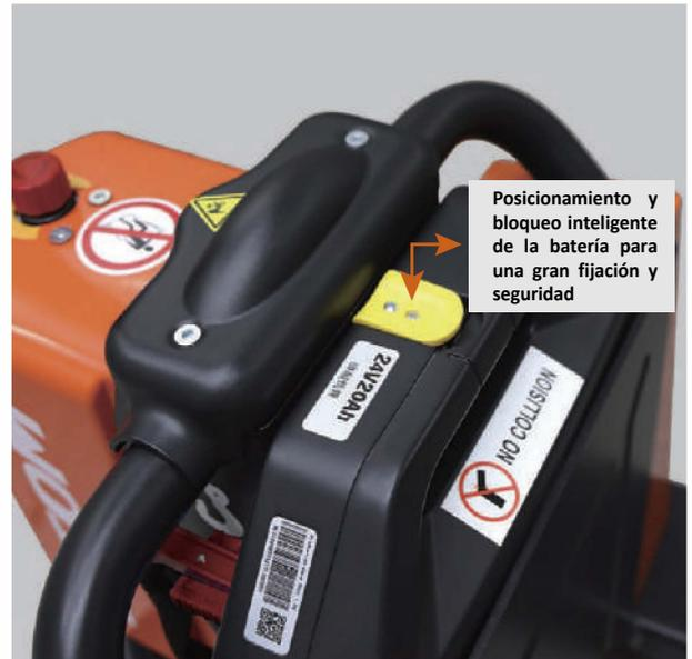
Posicionamiento y bloqueo inteligente de la batería para una gran fijación y seguridad
